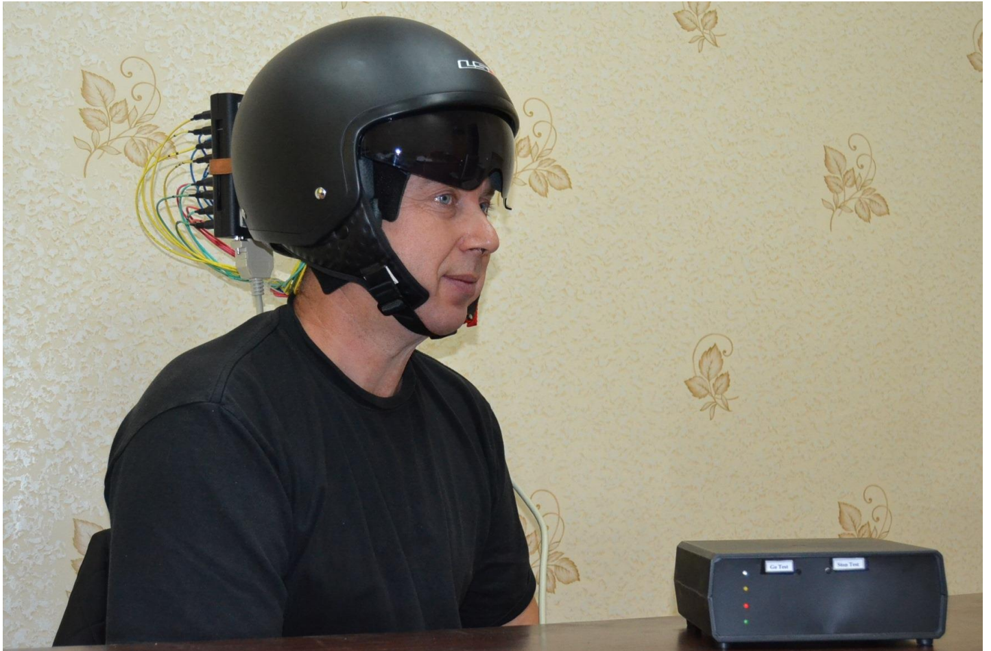
Випробування шолома, під'єданого до мікропроцесорного блоку управління
