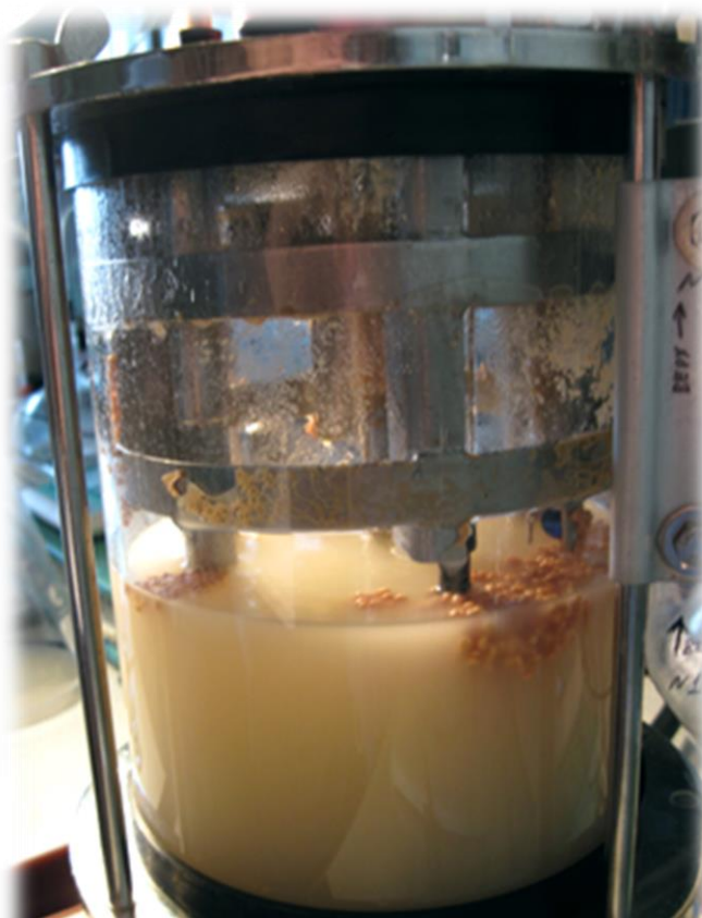
Спільне культивування штамів у середовищі із дизельним паливом у лабораторному ферментері Biotec
