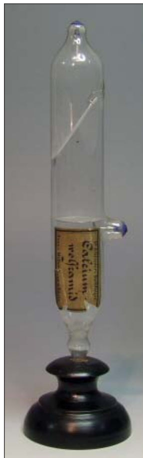
Рис. 3. Лампа Пулюя з антикатодом: в музейній експозиції (ліворуч) і в демонстраційному режимі роботи (праворуч)
