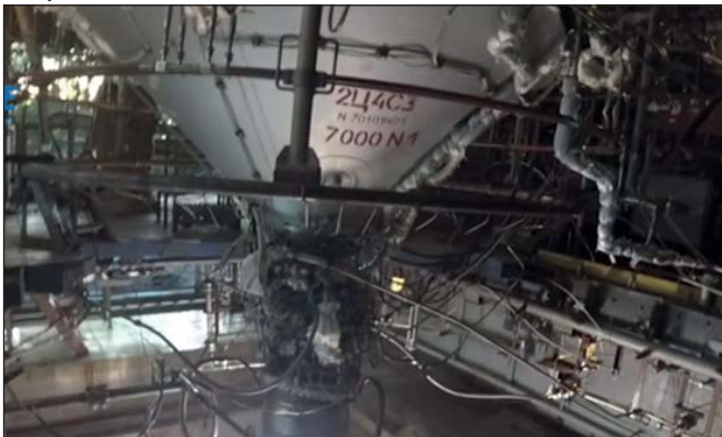
Вогневі випробування маршового двигуна верхнього ступеня ракети-носія «Циклон-4М» разом із керуючими двигунами малої тяги
