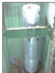
Натурний експеримент визначення руйнівних навантажень паливного баку ракетносія
