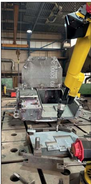
Виготовлення бойового модуля башти БМП-1 для модернізації машин під стандарт НАТО
