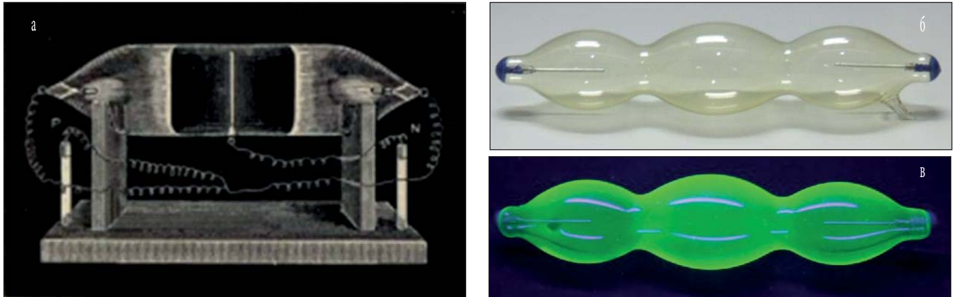
Рис 5. Розрядна трубка – перша з демонстрацій В. Крукса, в якій він показує відмінність своїх експериментів від М. Фарадея завдяки можливості досягнення більшого розрідження повітря в трубці (а) та ілюстрація впливу катодних променів в іншій розрядній трубці у відсутність напруги (б) та в режимі розряду (в)
