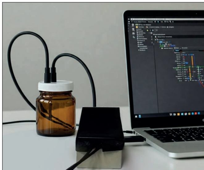
Рис. 8. Макет оптичного флуоресцентного сенсора летких сполук-біомаркерів (аміаку/ацетону)
