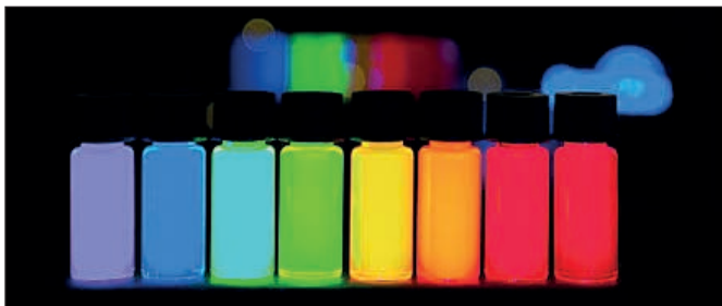
Рис. 5. Квантові точки з різним спектром випромінювання у вигляді колоїдних розчинів, опромінених УФ-світлом
