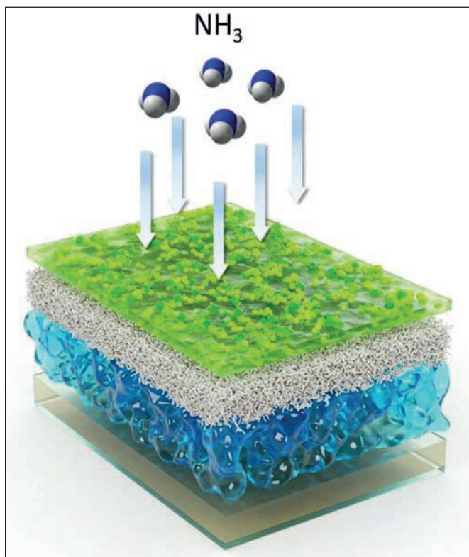
Рис. 9. Макет оптичного флуоресцентного сенсора летких сполук-біомаркерів (аміаку/ацетону)
