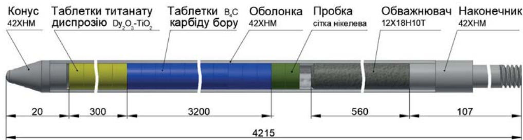
Рис.5. Конструкція ПЕЛ з таблетковим поглиначем (в якості альтернативи таблеток титанату диспрозію можуть застосовуватись таблетки гафнату диспрозію)
