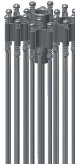
Рис. 4. Загальний вигляд ПС СУЗ
