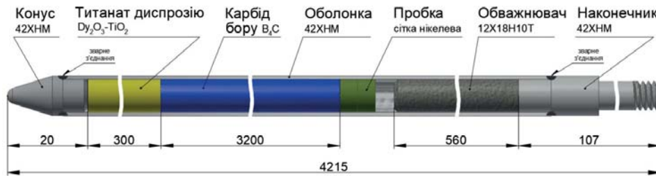
Рис.3. Альтернативна конструкція порошкового ПЕЛ реактора ВВЕР-1000, яка розроблена в НТК ЯПЦ
