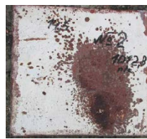
Куля Б-32 7,62x54 мм, відстань 50 мм, дистанція 30 м. Куплестійкість 226 пострілів/м 2
