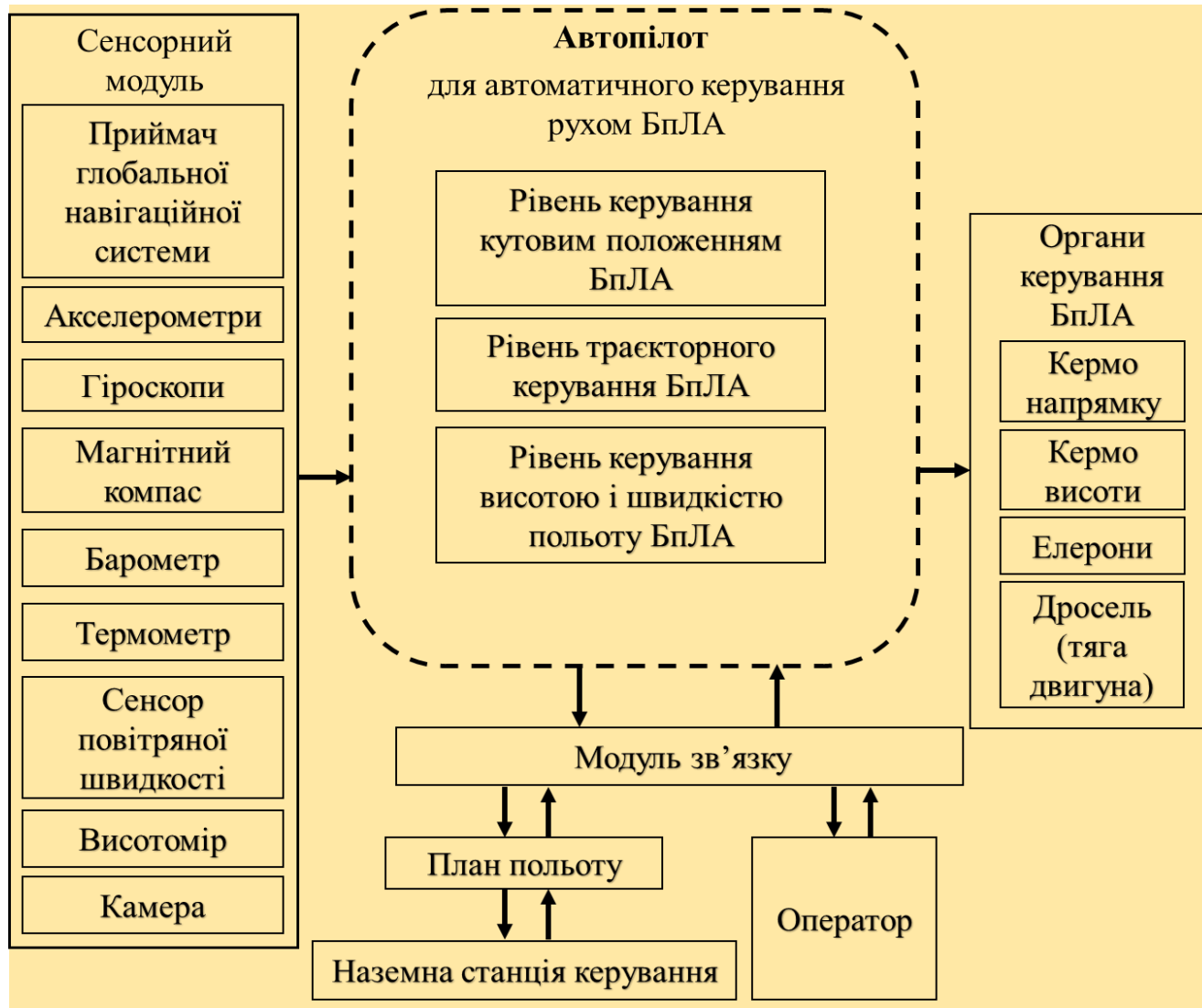
Ескіз зовнішнього вигляду системи керування (автопілота) для безпілотного літального апарату
