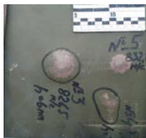
Куля Б-32 12,7x108 мм, відстань 50 мм, дистанція 30 м
