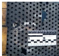
Куля Б-32 12,7x108 мм, відстань 50 мм, дистанція 30 м
