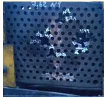
Куля Б-32 14,5x114 мм, відстань 50 мм, дистанція 30 м
