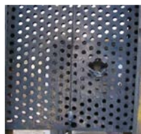
Куля Б-32 7,62x54 мм, відстань 50 мм, дистанція 30 м. Куплестійкість 226 пострілів/м 2
