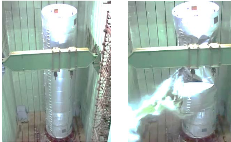
Натурний експеримент визначення руйнівних навантажень паливного баку ракетносія
