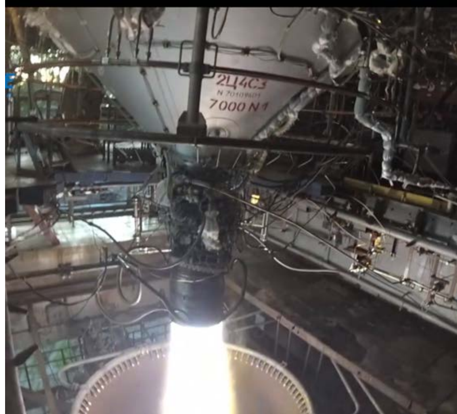
Вогневі випробування маршового двигуна верхнього ступеня разом з керуючими двигунами малої тяги
