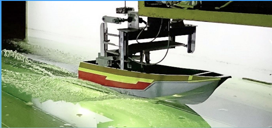
Модель судна типу WIG-craft для гідродинамічних досліджень і спосіб підвіски моделі до буксировочного возика
