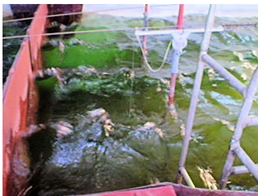
Розвинені хрестоподібні хвилі на поверхні води в дослідному басейні Інституту та хрестоподібні хвилі при випромінюванні звуку «співочим бокалом»
