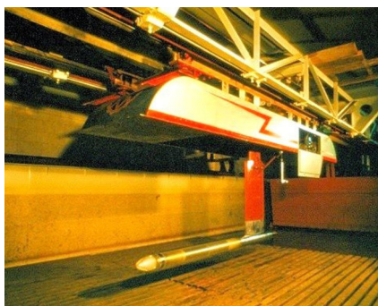
Моделі для досліджень різних методів керування примежовим шаром (у тому числі комбіноване КППШ – демпфуюче покриття з вприском полімерів) при буксируванні в гідроканалі при швидкості до 25 м/с
