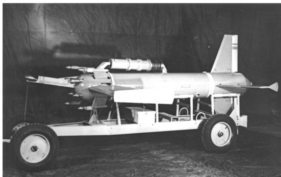
Буксирований вимірювач гідрофізичних полів ИГФП-1 на транспортувальному візку
