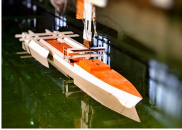
Модель трикорпусного судна в басейні Інституту гідромеханіки НАН України та зовнішній вигляд ракетного корвета «Мустанг», ДП «ДПЦК»
