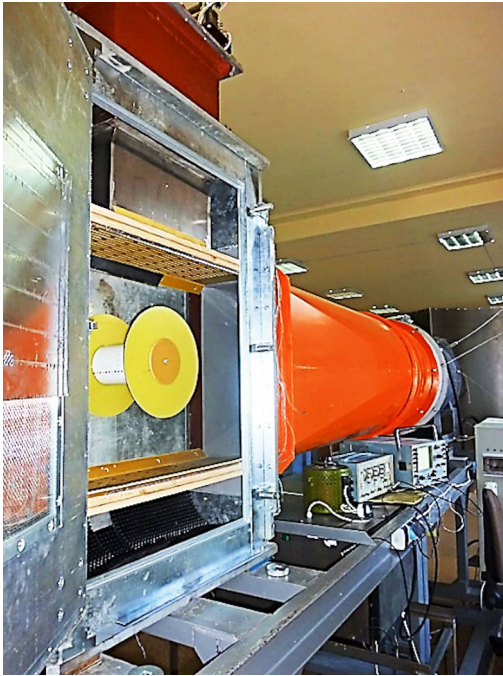
Аеродинамічна труба з керованими системами генерації плазових розрядів
