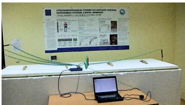
Експериментальний стенд для лабораторного моделювання потужності геотермальних теплообмінників
