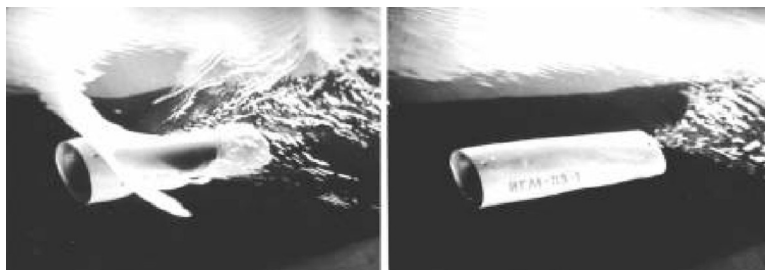
Буксирувальний режим руху моделі (ліворуч) і самохідний режим руху без поверхневих хвиль (праворуч)
