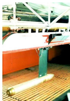
Моделі для досліджень різних методів керування примежовим шаром (у тому числі комбіноване КППШ – демпфуюче покриття з вприском полімерів) при буксируванні в гідроканалі при швидкості до 25 м/с
