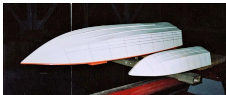
Характерний вигляд моделей водотоннажного (зліва) та глісуючого (справа) суден для випробувань в дослідному басейні за допомогою двох моделей
