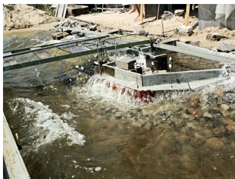
Хвильове навантаження на моделі споруд яхт-клубу у смт Паркове АР Крим (ліворуч) та захисних споруд у бухті Двоаякірна (праворуч)
