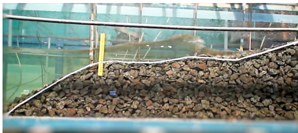
Обгороджувальна дамба Морського підхідного каналу глибоководного суднового ходу Дунай – Чорне море (ліворуч) та експериментальне моделювання рекомендованої посиленої конструкції дамби (праворуч)
