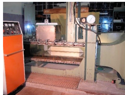
Гідродинамічна труба (ГДТ). Робоча ділянка 400 × 400 × 1700 мм. Стінки прозорі. Швидкість до 2 м/с
