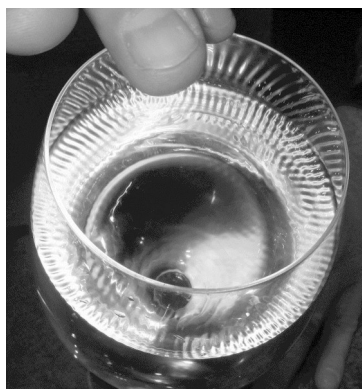
Розвинені хрестоподібні хвилі на поверхні води в дослідному басейні Інституту та хрестоподібні хвилі при випромінюванні звуку «співочим бокалом»
