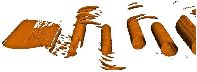
Формування вихрового сліду при коливному русі крила
