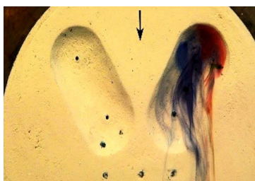
Формування вихрової течії і викид вихорів назовні зі сферичної лунки та пари овальних лунок: чисельне та фізичне моделювання
