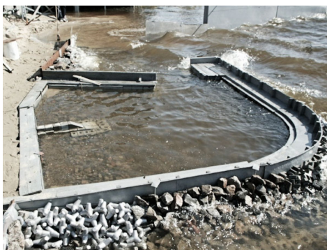
Хвильове навантаження на моделі споруд яхт-клубу у смт Паркове АР Крим (ліворуч) та захисних споруд у бухті Двоаякірна (праворуч)
