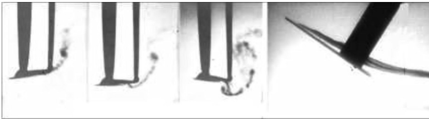
Картини вихрового сліду за підводним крилом
