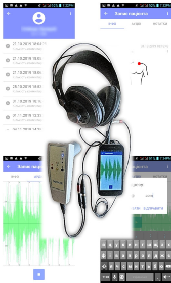
Електронний стетоскоп медичного призначення ЕФОН-08 при роботі зі смартфоном, устаткованим спеціалізованим програмним додатком
