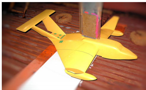
Схематизований вигляд моделі для аеродинамічних досліджень і спосіб підвіски моделі до буксировочного возика дослідного басейну
