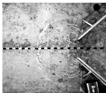
Загальний вигляд відкритої кутової стінки та перетворення хвильового руху у вихровий
