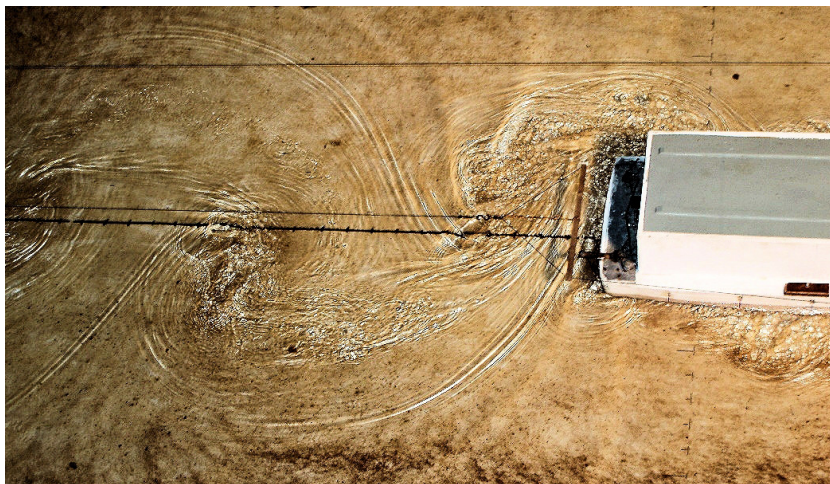
Специфічний відрив потоку за кормою судна в умовах суттєвого обмеження глибини фарватеру
