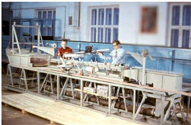
Гідродинамічний стенд для дослідження пристінних течій: дослідники В.В.Бабенко, В.І.Коробов
