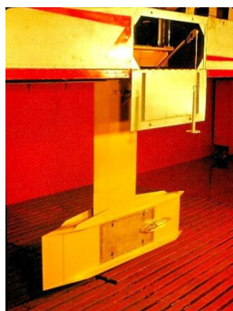
Моделі для досліджень різних методів керування примежовим шаром (у тому числі комбіноване КППШ – демпфуюче покриття з вприском полімерів) при буксируванні в гідроканалі при швидкості до 25 м/с
