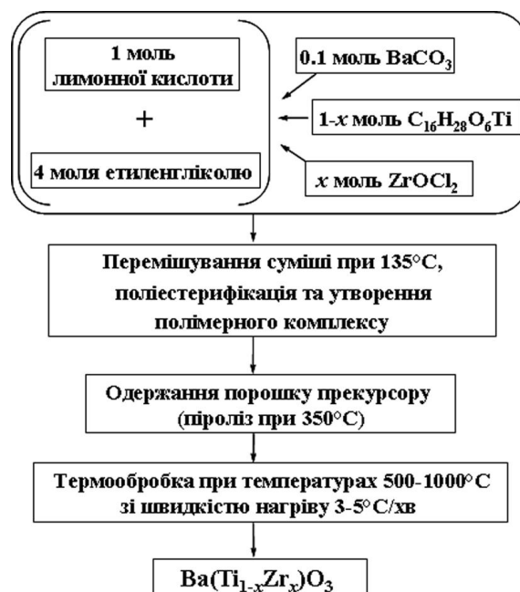
Рис. 1. Схема синтезу твердих розчинів \text{BaTi}_{1-x}\text{Zr}_x\text{O}_3 ( 0.2 \leq x \leq 0.3 ) золь-гель методом.
