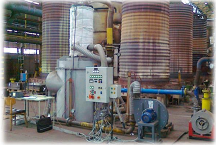
Рекуператор РРД на промисловій ковпаковій термічній печі та дослідній установці для його випробувань (металургійний комбінат «ISD DUNAFERR», м. Дунауйварош, Угорщина)
