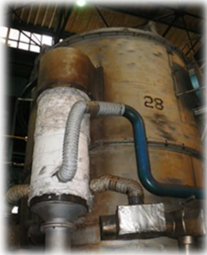
Рекуператор РРД на промисловій ковпаковій термічній печі та дослідній установці для його випробувань (металургійний комбінат «ISD DUNAFERR», м. Дунауйварош, Угорщина)
