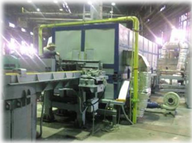
Прохідна піч термічної обробки заготовок продуктивністю 2,5 т / год з рекуператором типу РРД в ковальському цеху автозаводу «МАЗ» (м. Мінськ, Республіка Білорусь)
