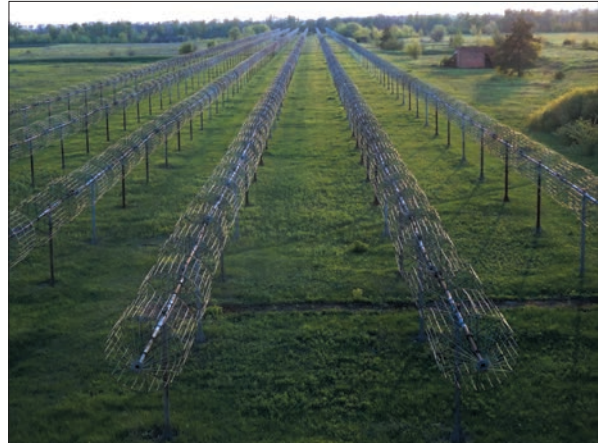
Рис. 2. Панорама радіотелескопа УТР-2, ефективна площа якого становить 150 000 м 2
