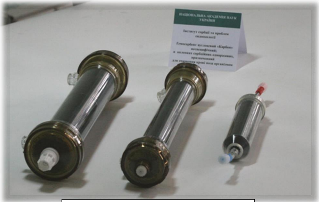
Сорбційні колонки, заповнені вугіллям «КАРБОН»
