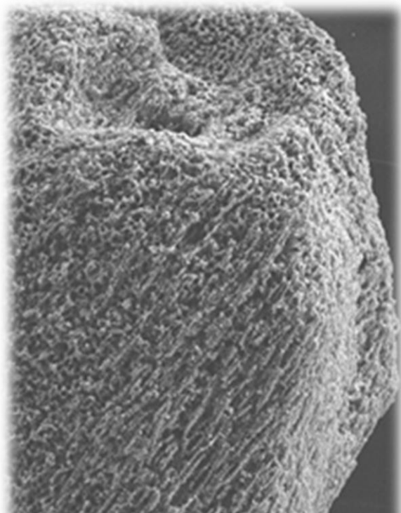
Фрагмент гранули вугілля «КАРБОН» (збільшення у 100 разів)
