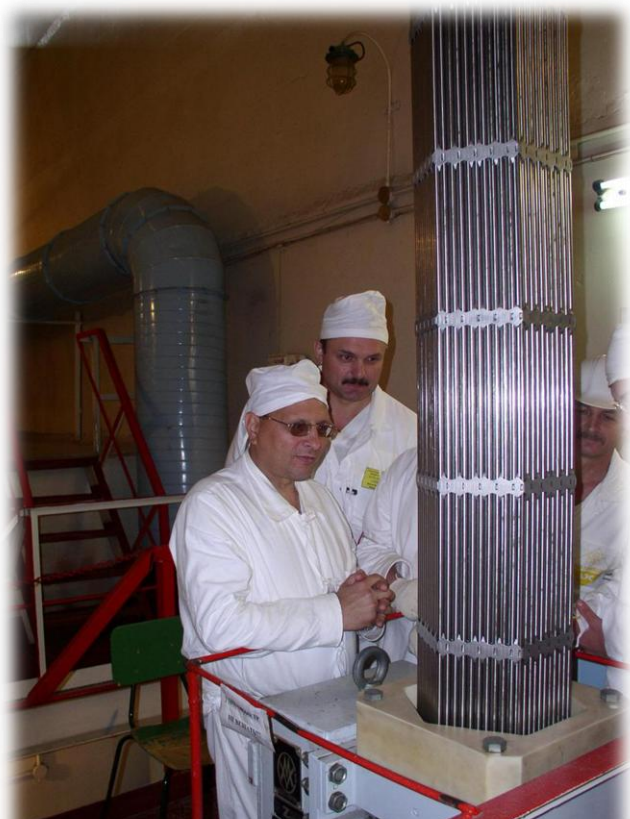
Установка ТВЗВ в стапель та проведення контрольних операцій з перевірки форми ТВЗВ
