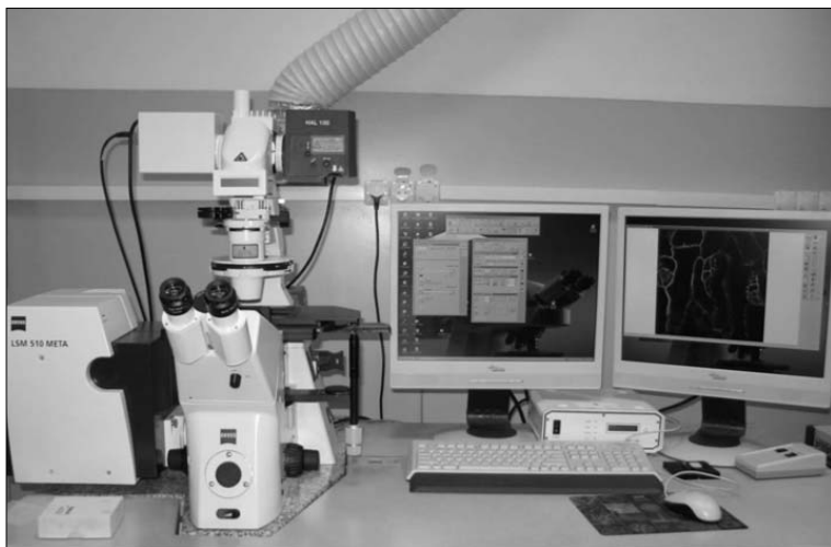
Рис. 2. Конфокальний лазерний скануючий мікроскоп LSM 510 META (Carl Zeiss, Німеччина)
